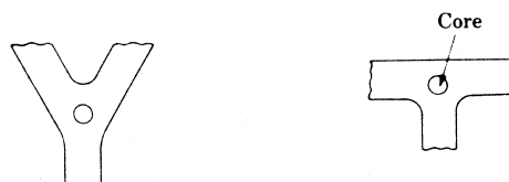
Figuur 2.11: Voorbeelden van de toepassing van kernen om materiaal-ophoping te verminderen.
